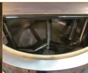
котел варочный с двумя мешалками
